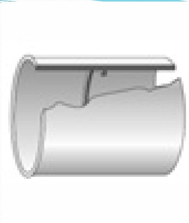
Les manchons : Dans différents diamètres, permet la liaison droite de deux tubes.
